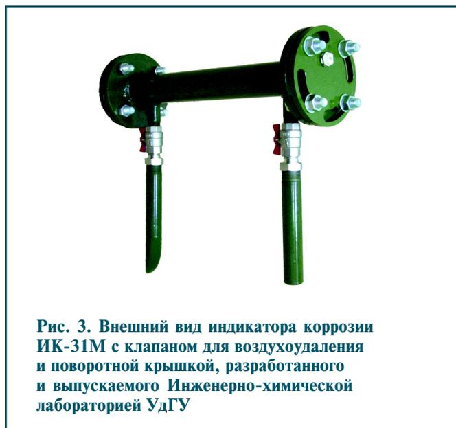
**Рис. 3. Внешний вид индикатора коррозии ИК-31М с клапаном для воздухоудаления и поворотной крышкой, разработанного и выпускаемого Инженерно-химической лабораторией УдГУ**
