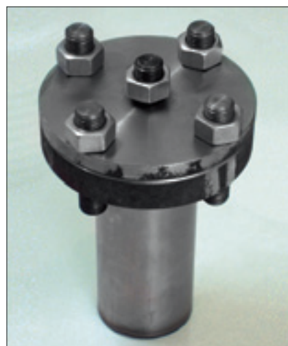
■ Рис. 2. Автоклавная ячейка для проведения коррозионных испытаний при повышенных температурах (а — в разобранном виде (на штоке-держателе видна изолирующая оболочка и изолирующий дистантор); б — в собранном виде, подготовленная к установке в термостат)
