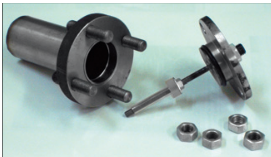
■ Рис. 2. Автоклавная ячейка для проведения коррозионных испытаний при повышенных температурах (а — в разобранном виде (на штоке-держателе видна изолирующая оболочка и изолирующий дистантор); б — в собранном виде, подготовленная к установке в термостат)
