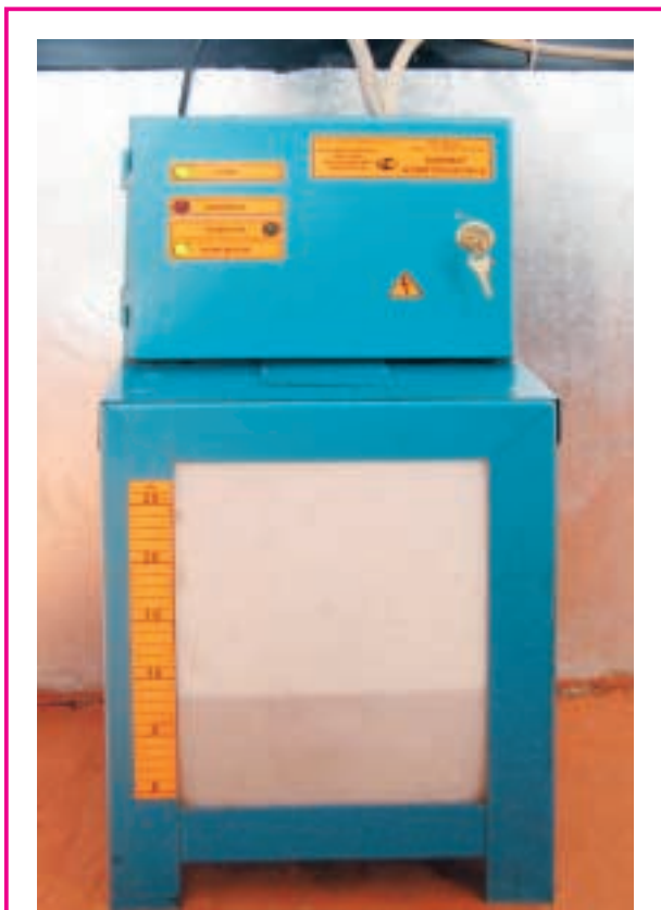
■ Рис. 8. Автоматическая система дозирования реагентов «Комплексон 6»
