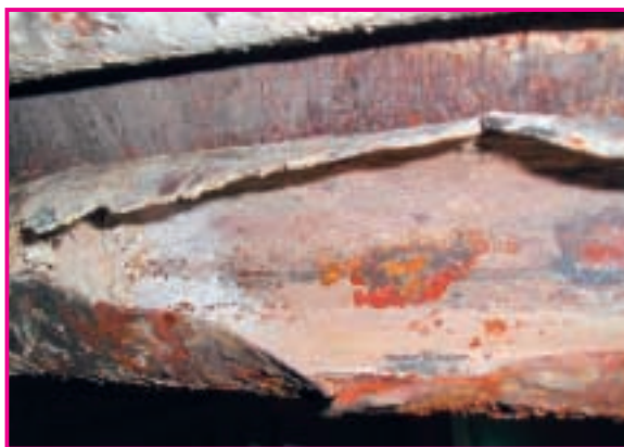
■ Рис. 2. Образцы экранных труб с перфорацией (разрывом) заполненных внутри бело-серым веществом
