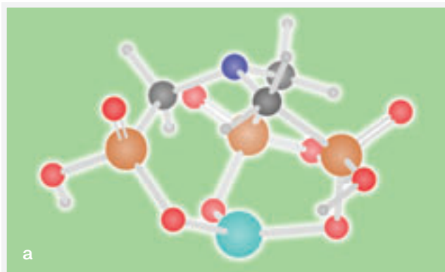
■ Рис. 1. Модель процесса ингибирования солеотложений (а — структура нитрилотриметилфосфонатного комплекса кальция, рассчитанная методами квантовой химии; б — встраивание нитрилотриметилфосфонатного комплекса в поверхность зародыша кристалла кальцита; в — геометрические размеры наименьшего зародыша кристалла, рост которого могут тормозить фосфонатные комплексы)
