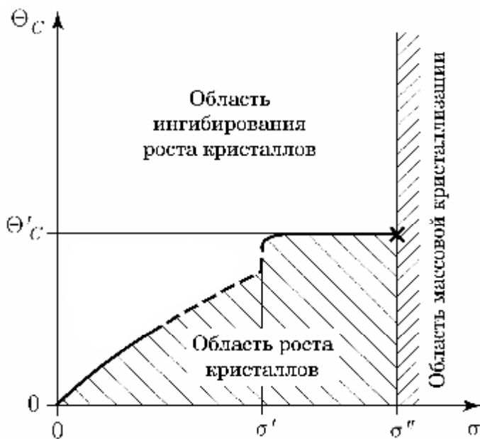
Рис. 4. Зависимость критической степени покрытия поверхности ингибитором \Theta_C от относительного пересыщения раствора \sigma , описываемая при помощи феноменологической и микроскопической моделей, разработанных в § 2.1 и § 2.2.
