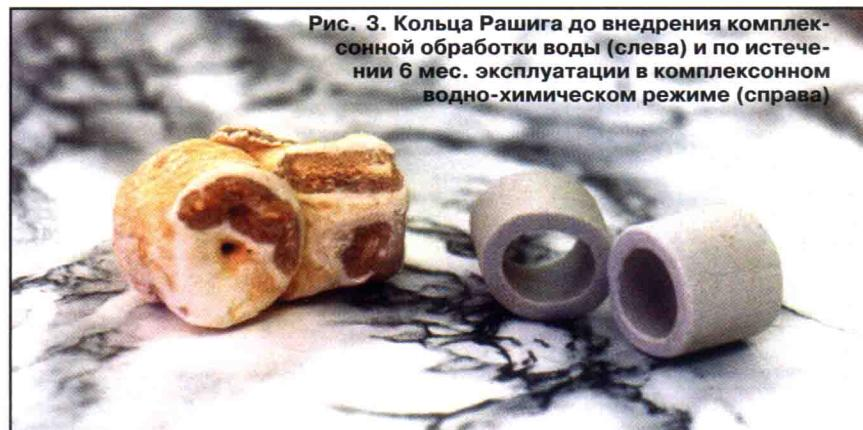
Рис. 3. Кольца Рашига до внедрения комплексной обработки воды (слева) и по истечении 6 мес. эксплуатации в комплексном водно-химическом режиме (справа)
