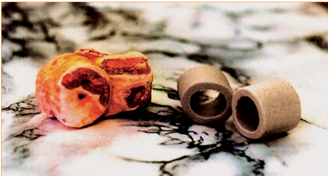
Рис. 3. Заполнитель деаэратора (кольца Рашига) до внедрения комплексонной обработки воды и по истечении 6 месяцев эксплуатации в комплексонном водно-химическом режиме
