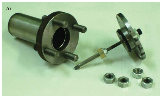
Рис. 1. Внешний вид (а) и схема (б) автоклавной ячейки для проведения высокотемпературных коррозионных испытаний: 1 — корпус; 2 — днище; 3 — фланец; 4 — вставка; 5 — шток-держатель образцов; 6 — гайка; 7 — изолирующая дистанционная прокладка; 8 — испытуемый образец; 9 — уплотнительное резиновое кольцо; 10 — крышка; 11 — шпилька; 12 — крепёжная гайка; 13 — вспомогательная гайка для извлечения вставки
